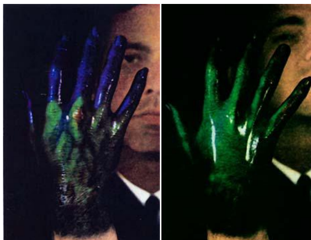
Sliki 8 in 9 (Vir: Opticsexcellence.org ) prikazujeta moško roko, ki je prekrita s črno barvo, katera vsebuje termično občutljiv holesterični tekoči kristal.
