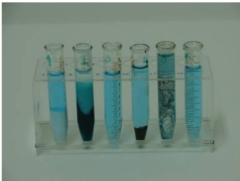
Slika 7: Reakcije odstranjevanja \text{Cu}^{2+} ionov iz odpadne vode
