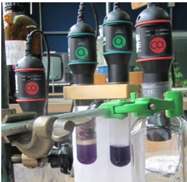
Slika 3: Fotografija - namestitev kalečih semen, indikatorja in senzorjev za CO 2 in O 2
