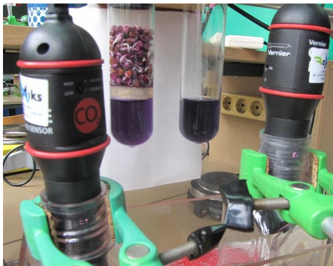
Slika 2: Fotografija - namestitev kalečih semen, indikatorja in senzorja za CO 2 in O 2
