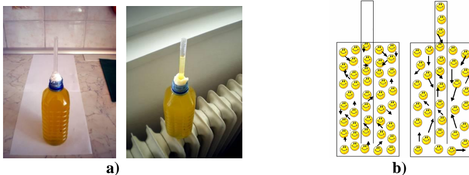
Slika 2: Raztezanje kapljavine s spremembo temperature: a) plastenka s sokom na hladnem in na topli radiatorju, b) shematični prikaz raztezanja kapljavine z molekularno sliko snovi
