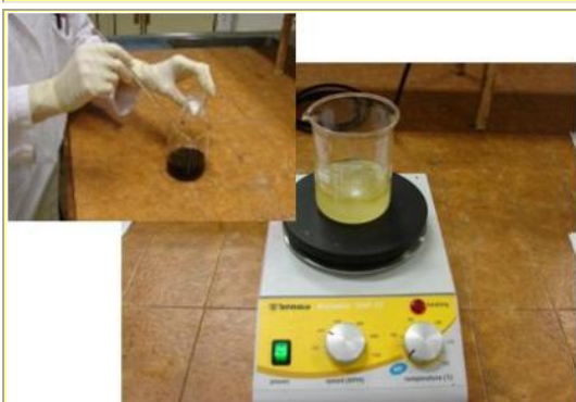
Slika 34: Sušenje kofeinskega ekstrakta ob dodatku sušilnega sredstva
