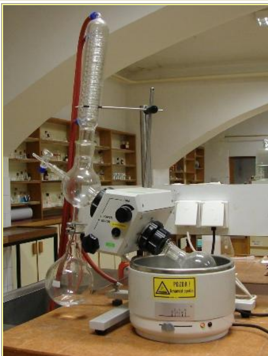
Slika 36: Odporevanje topila z rotavaporjem
