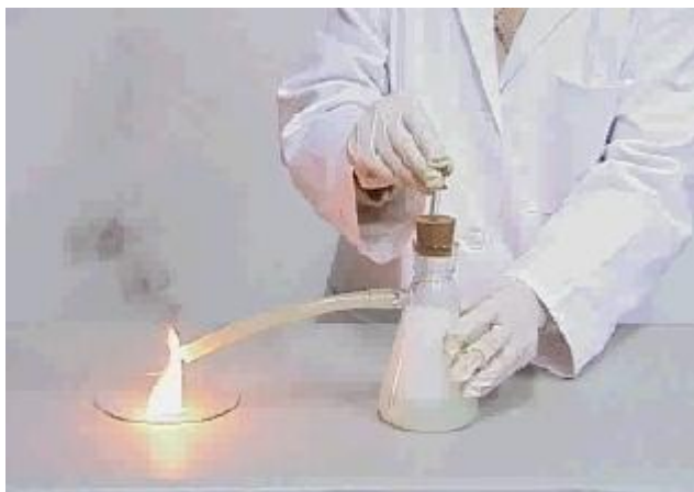
Slika 15: Izdelava gasilnega aparata (za ogled videoposnetka delovanja v šolskem laboratoriju izdelanega gasilnega aparata si oglejte e-verzijo gradiva)
