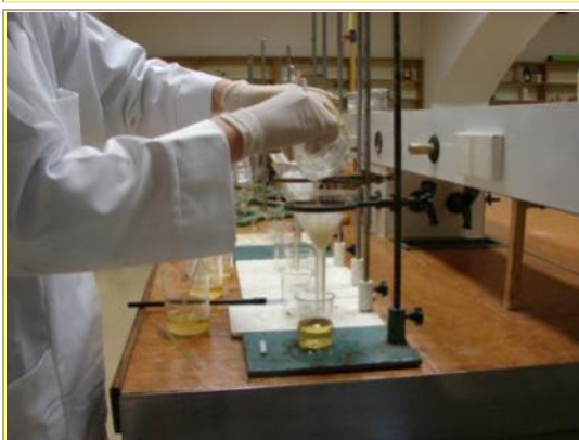
Slika 33: Izolacija kofeina iz kavnih napitkov s 3-kratno ekstrakcijo z diklorometanom
