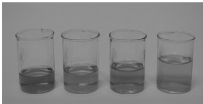
Slika 2. 15 mL 0,1 M HCl postopno dodajamo 0,1 M NaOH. Reakcijo spremljamo z indikatorjem iz barvil rdečega zelja, ki smo ga dodali klorovodikovi kislini.
