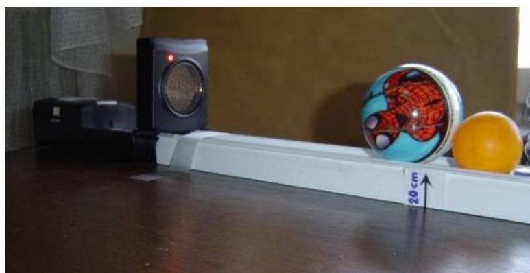
Slika 5: Poizkus z ultrazvočno detekcijo gibanja žoge po strmini
