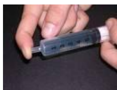
Slika 20: Plin shranjujemo tako, da ga stisnemo. Pri tem se plin običajno spremeni v kapljevino
