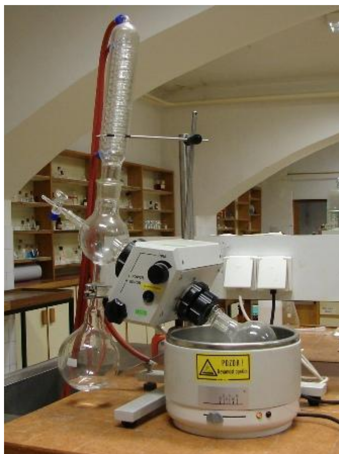
Slika 23: Odparevanje topila z rotavaporjem
