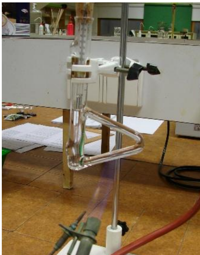
Slika 26: Thielejev aparat sestavimo za določanje tališča
