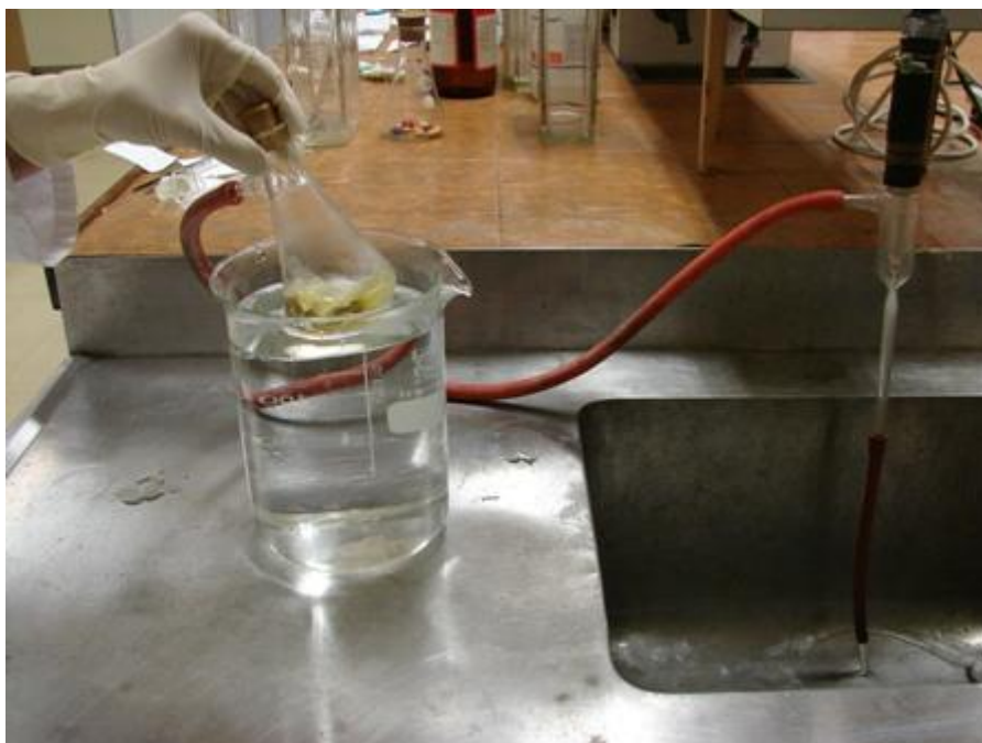
Slika 24: Topilo lahko odparimo tudi z "improviziranim" rotavaporjem
