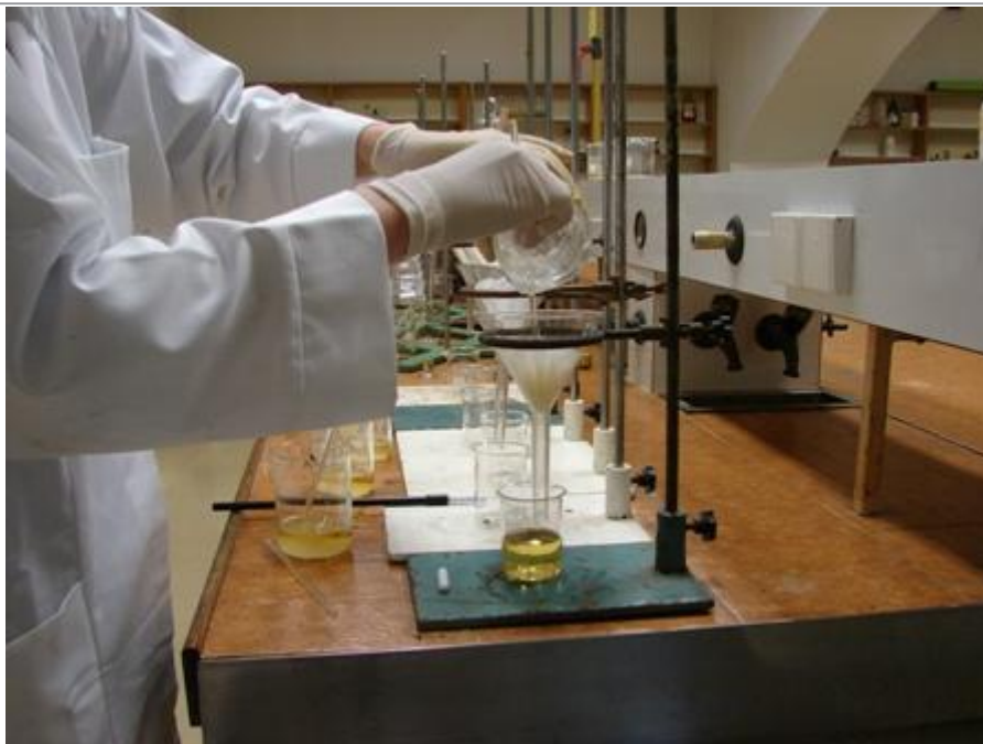
Slika 22: Odstranjevanje sušilnega sredstva iz ekstrakta s filtracijo
