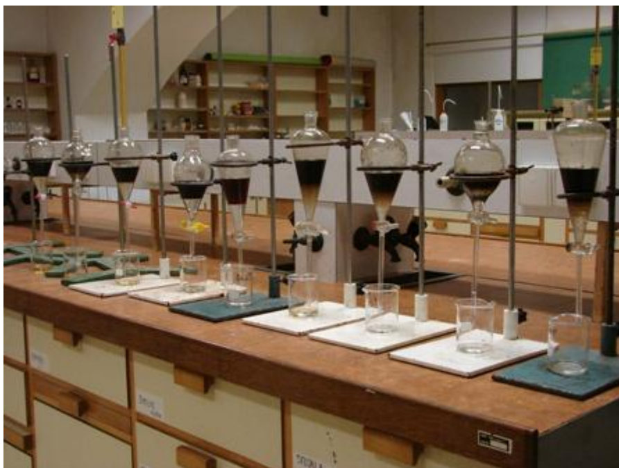
Slika 20: Izolacija kofeina iz kavnih napitkov s 3-kratno ekstrakcijo z diklorometanom
