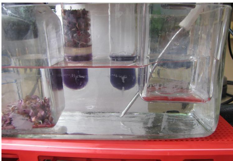
Slika 7: Fotografija - namestitev kalečih semen, indikatorja in senzorjev za CO 2 in O 2 v vodno kopel z določeno temperaturo
