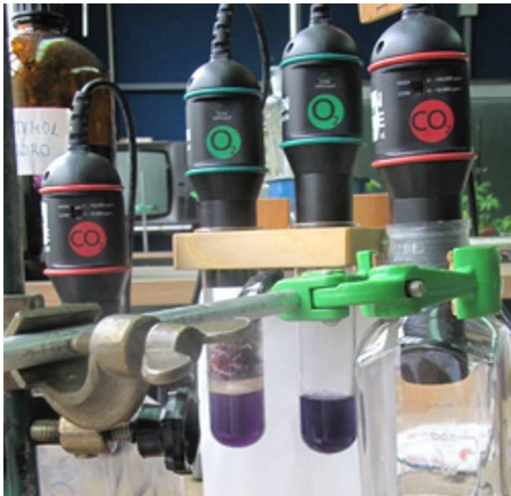
Slika 3: Fotografija - namestitvev kalečih semen, indikatorja in senzorjev za CO 2 in O 2
