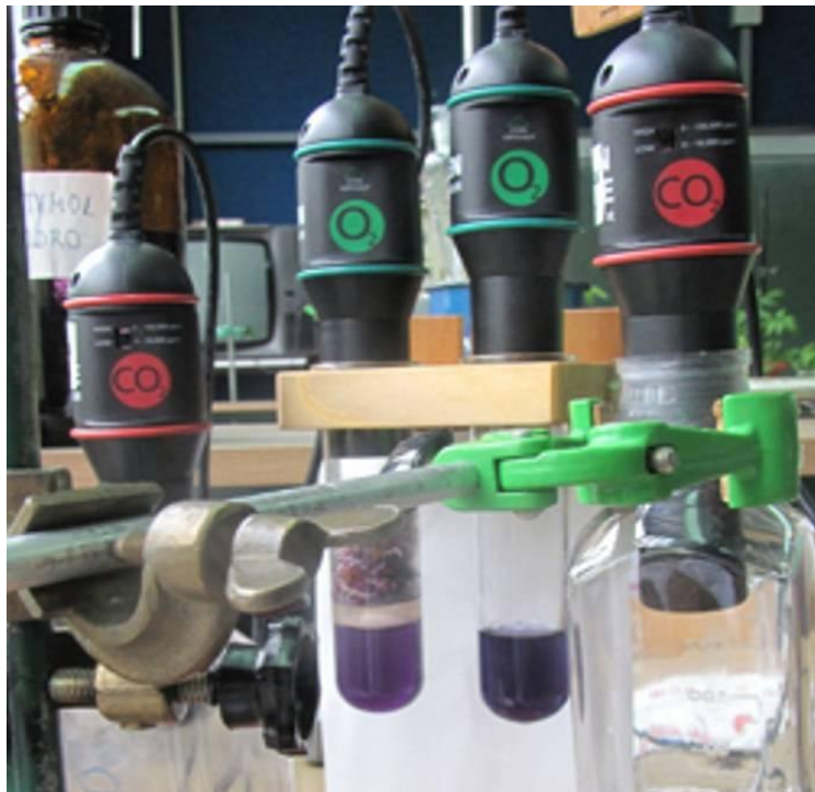
Slika 4 : Fotografija - namestitev kalečih semen, indikatorja in senzorjev za CO 2 in O 2
