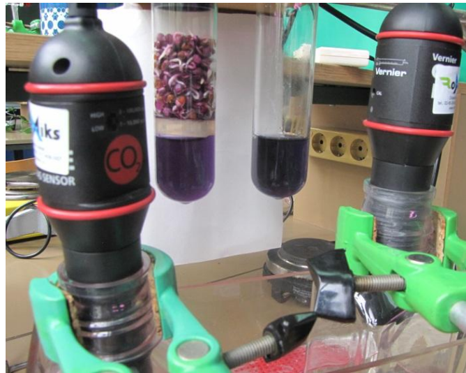
Slika 2: Fotografija - namestitvev kalečih semen, indikatorja in senzorjev za CO 2 in O 2 NAVODILO
