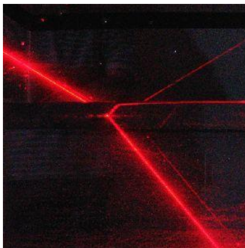
Slika 4: Lom laserskega žarka na meji med zrakom in vodo. (vir: http://www.warren-wilson.edu/~physics/PhysPhotOfWeek/20050401LaserRefraction/LaserRefractn.jpg )
