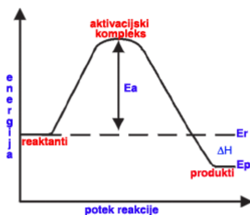
Slika 39: Diagram energijskih sprememb pri eksotermni reakciji. [4]
