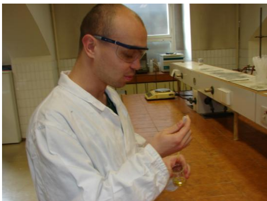
Slika 26: Preverjanje prisotnosti etanola v v alikvotu odvzetem med alkoholnim vrenjem
