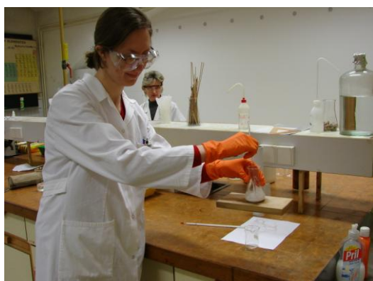
Slika 20: Pri poteku endotermne reakcije kapljica vode pod erlenmajerico z reakcijsko zmesjo »prilepi« deščico na erlenmajerico
