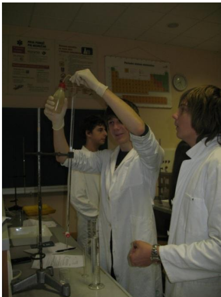
Slika 6: Najprej določimo prostornino negraduirnega dela birete
