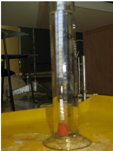
Slika 8: Opazujemo reakcijo, ki poteka na traku magnezija (priporočljiva masa Mg za 50 mL bireto je manj kot 0,050g)
