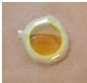
Slika 24: Reakcija sinteze tekočega kristala MBBA je potekla, če pri ohlajanju postane kapljica zmesi motna
